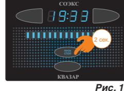
• Для постановки таймера на паузу или снятия с паузы необходимо кратковременно нажать кнопку «пуск/стоп» (рис. 12).
