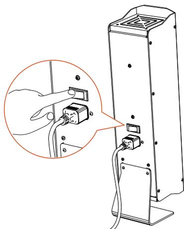
6.5. Включите очиститель воздуха с помощью рокового выключателя на корпусе. Включится подсветка клавиши, индицирующая подачу питания на цепи прибора.
