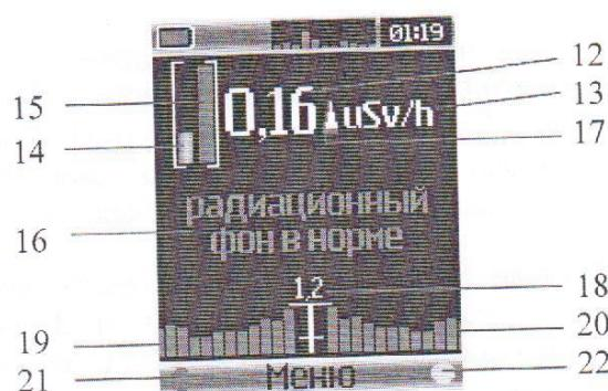
12) Уровень радиоактивности. Значение МАЭД. Отображается крупными цифрами в центре экрана. При первом измерении отображается слово «ИЗМЕРЕНИЕ».
